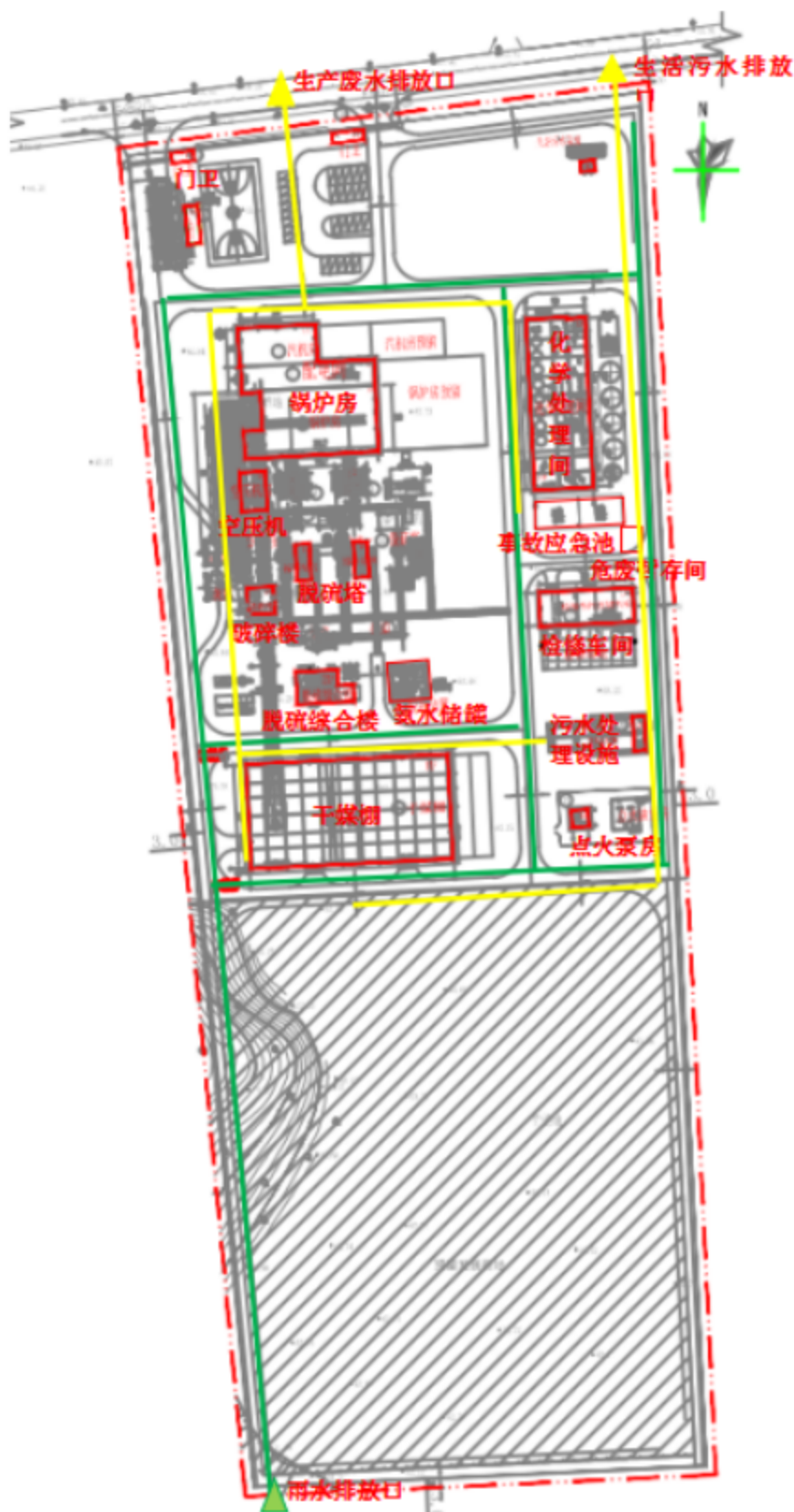
图 3.1-4 厂区雨水、污水管网图
