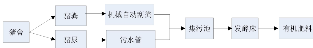
图 3.6-2 粪污处理工艺流程图
