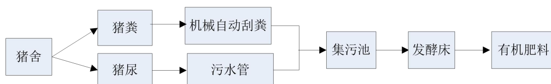
图 3.4-2 粪污处理工艺流程图
